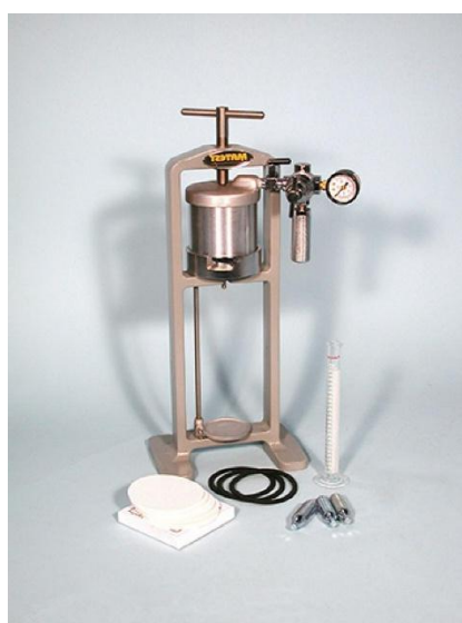
10-rasm b). API filtratsiya pressi – Burg‘ilash eritmasi filtratsiyasini aniqlash uskunasi
