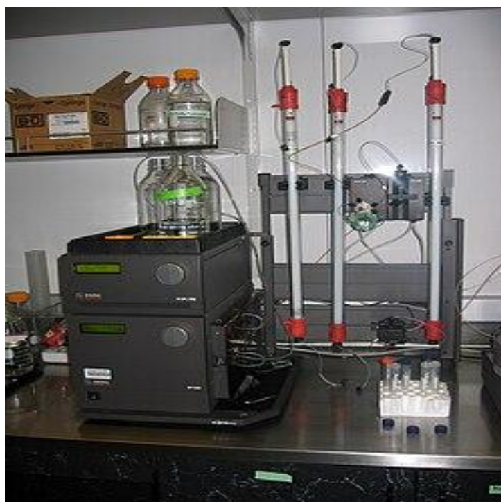
5-rasm. Gel-permeatsion xromatograf (GPC) – Molekulyar massa va polidisperslikni aniqlash uskunasi
