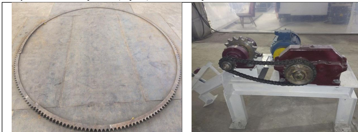
Рисунок 4. Фрагмент процесса изготовления зубчатого венца и ведущего цепного привода
