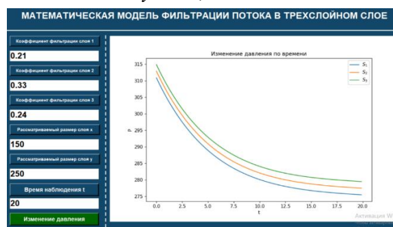
Рис. 1.4. Определение понижения напоров на галерее скважин при S_1=0.21 , S_2=0.33 , S_3=0.24 , x=150 , y=250 , t=20 .
