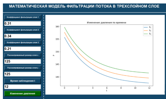
Рис. 1.2. Определение понижения напоров на галерее скважин при S_1=0.31 , S_2=0.34 , S_3=0.21 , x=125 , y=125 , t=12 .
