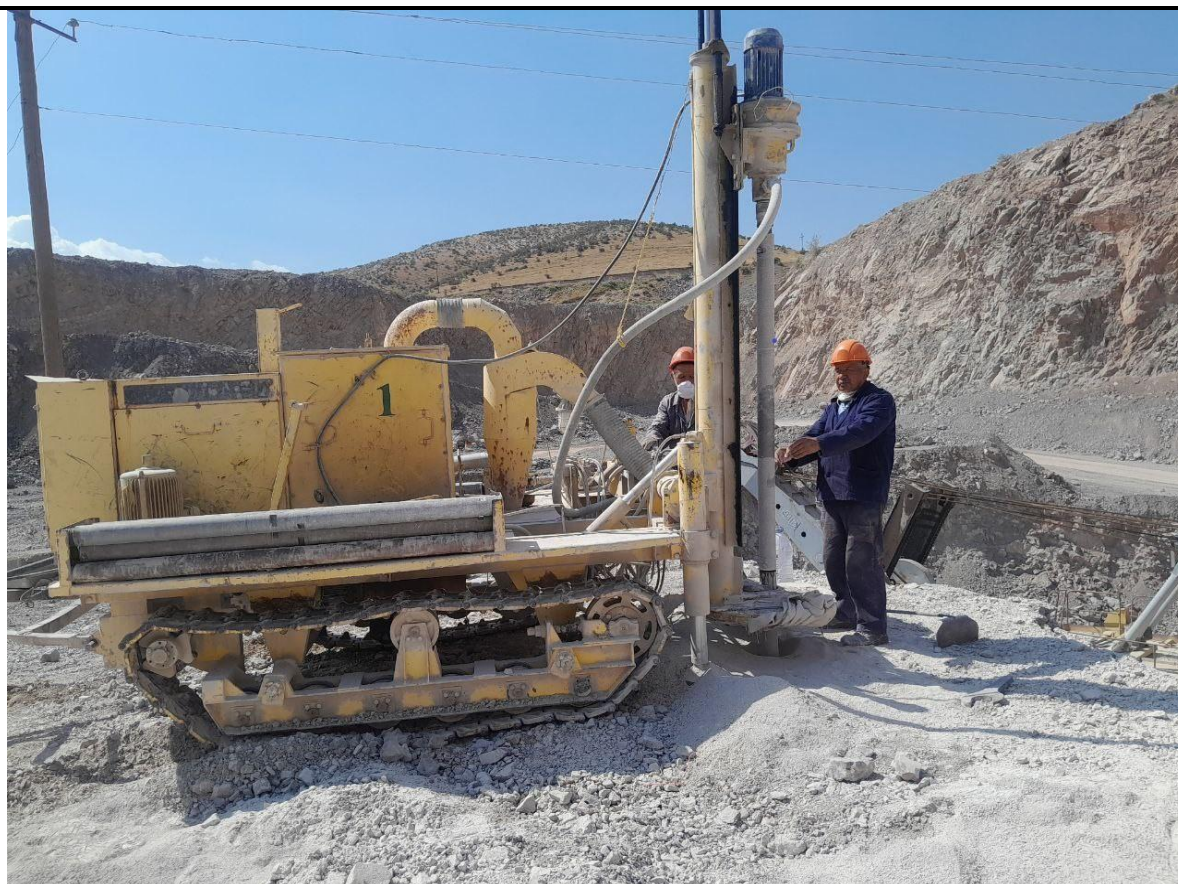
Фото-2. Бурение скважин на карьере известняков Саук-булак.
