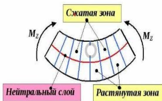
Рисунок-1. Нормальные напряжения при изгибе
