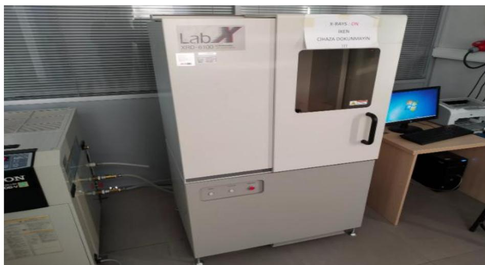
Рис.1. Порошковая рентгеновская дифрактометрия. XRD-6100.
