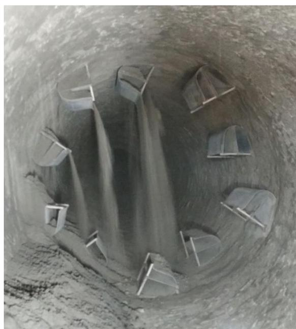
Рис. 5. Установка предлагаемой насадки на барабан.
