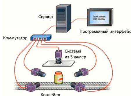
Рис. 4. Система из 5 камер для контроля качества продукции на конвейере
