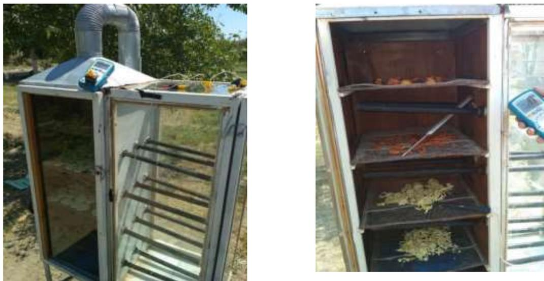
**Рис. 6. Лабораторная сушильная установка с использованием ТТ**
